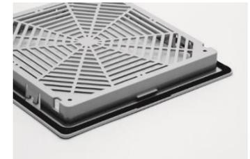
Enclencher le filtre dans la découpe du panneau à l'aide d'un tournevis approprié afin de pouvoir insérer soigneusement toutes les pinces dans la découpe.
